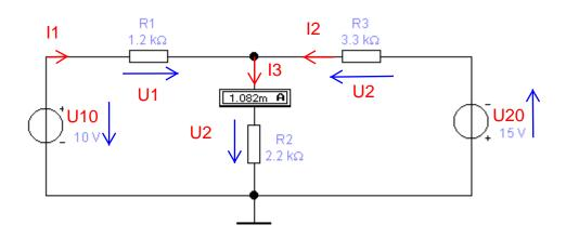
$$U_{10} \coloneqq 10 \cdot V \quad U_{20} \coloneqq 15 \cdot V \quad \quad R_1 \coloneqq 1.2 \cdot k\Omega \quad \quad R_2 \coloneqq 2.2 \cdot k\Omega \quad \quad R_3 \coloneqq 3.3 \cdot k\Omega$$
